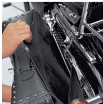
» Das rückwärtige Fach der Satteltasche von unten am Abstandshalter einhängen, die Satteltasche hochziehen, den Drehverschluss der Halteplatte befestigen. Mit Sicherheitsstift (Art. 4720) und Schloss (Art. 4721 oder 4725) sichern.
