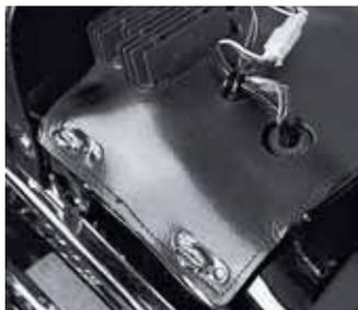
» Wählen Sie für Ihr Motorrad die exakt angepasste Halteplatte und befestigen Sie diese unter dem Sitz.
