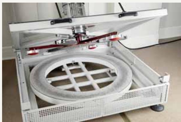
Der Abrieb wird auf der Darmstadtmaschine durchgeführt.
